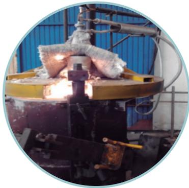
A maioria dos metais tem um ciclo de reutilização quase infinito. A fundição é um processo metalúrgico que aproveita esta característica dos metais para os voltar a fundir e dar origem a um produto novo. Os elementos principais de uma fundição são o forno, a colher de vazamento e os moldes.
